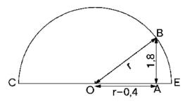
Il camion non può passare; impostando, infatti, un passaggio esattamente al centro della galleria, la larghezza dell'autocarro di 2,40 m richiederebbe una altezza dell'autocarro di 4,08 m contro i 4,10 m effettivi.
