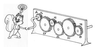
Nel dispositivo presentato in figura i numeri scritti a lato delle ruote dentate indicano i numeri dei denti della ruota corrispondente.
